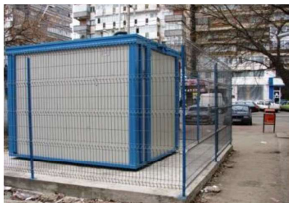
Figură 10: Stație de monitorizare automată
